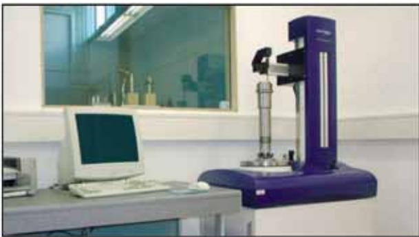
Rundlaufmessmaschine (zur Prüfung rotationssymmetrischer Teile einer Spindel)
