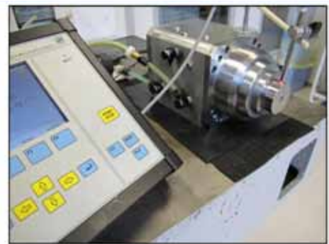
Feineinstellung der Wuchtgüte an der Spindel
